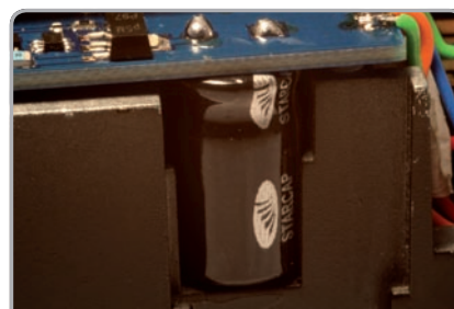
Kontaktsicher: PowerPack Energiespeicher
