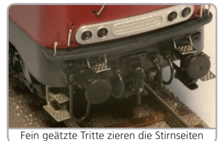
Trittstufe schwenkt in engen Kurven aus
